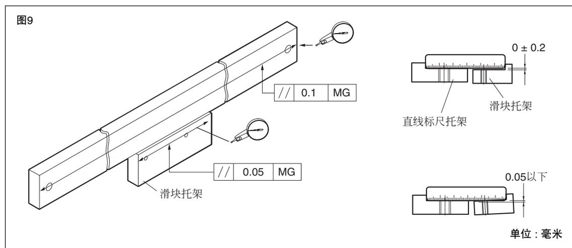
2. 一边用度盘规测量\* 直线标尺背面，一边基于直线标尺背面的机械定位标识调节平行度，然后旋紧固定螺丝。
