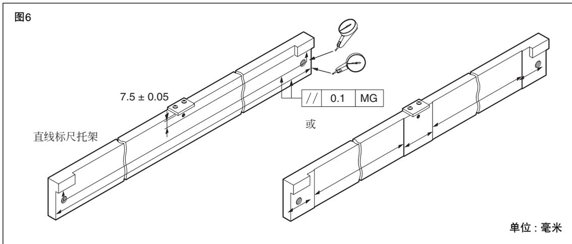
2. 确认并调整滑块托架的高度和平行度, 然后加以固定。
