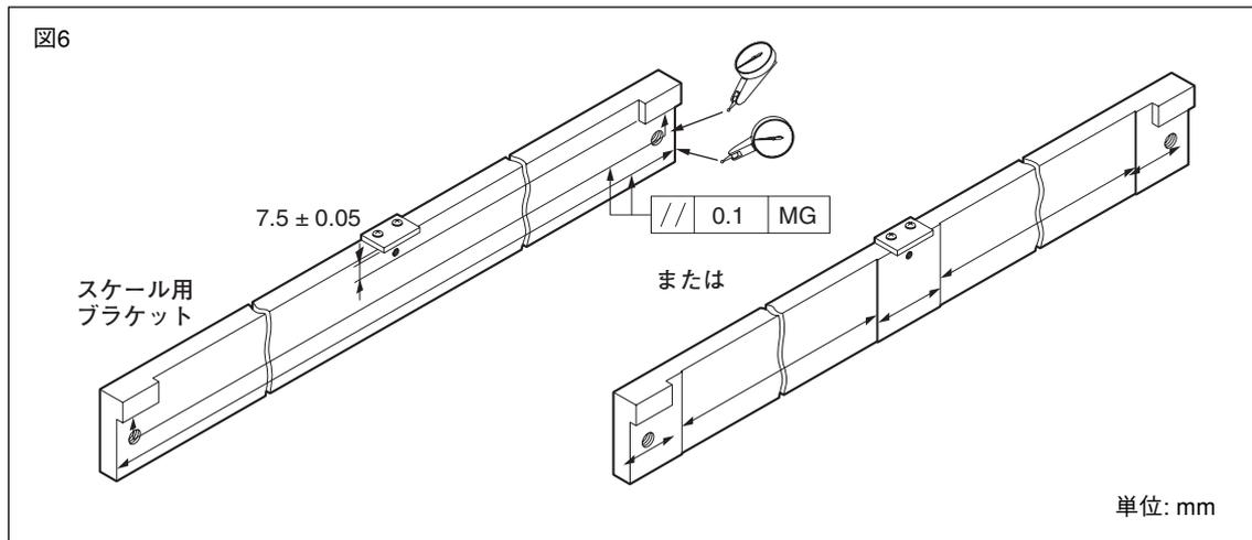
2. スライダ用ブラケットの高さと平行度を確認、調整し、固定します。
