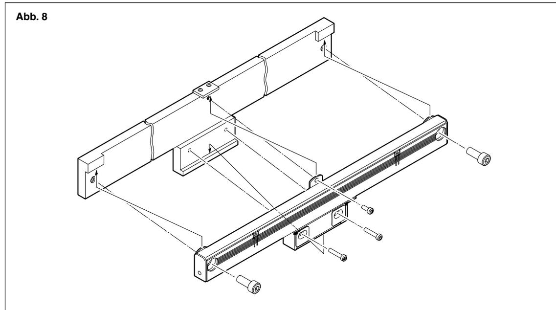
**Beispiel 2: Montage, bei der keine Anschlagfläche von Maßstab und Schieber mit dem Halter erzeugt wird**
