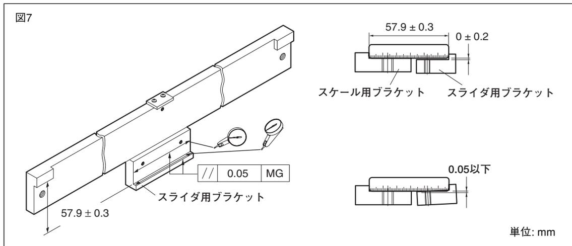
3. スケールを各突き当て面に突き当てて、取付けます。
