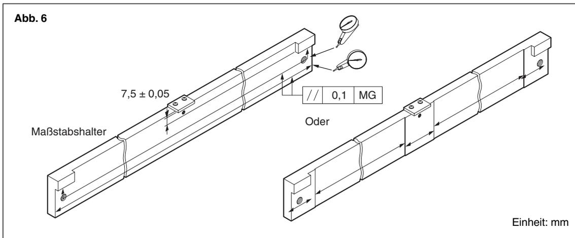
2. Höhe und Parallelität des Schieberhalters überprüfen und einstellen, und dann das Teil befestigen.
