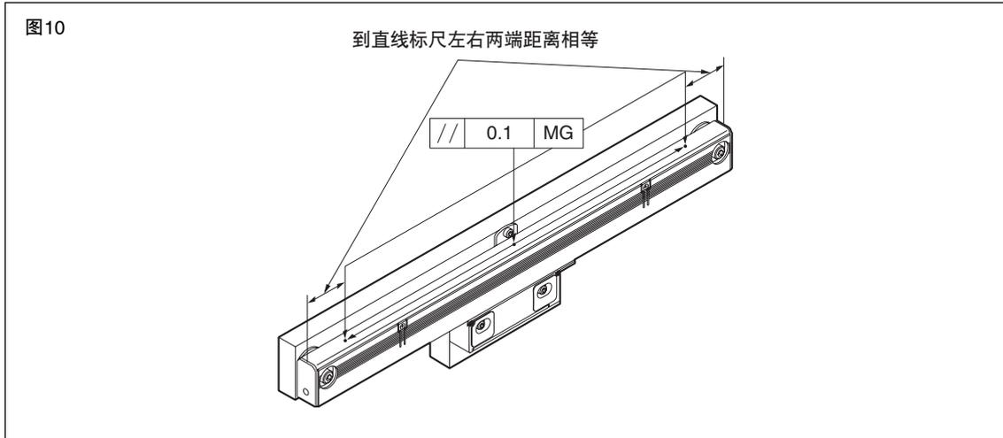
3. 在直线标尺和滑块之间的缝隙处插入附属的隔板 ( $t = 1.0 \text{ mm}$ )，然后一边让滑块接触直线标尺，一边调整滑块位置。
