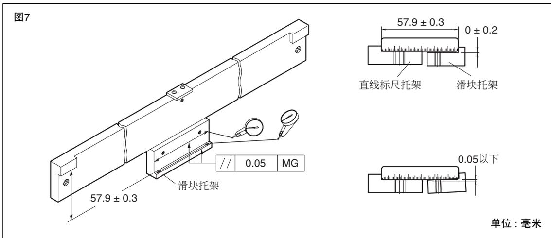
3. 令直线标尺与各个挡板相接触，然后进行安装。
