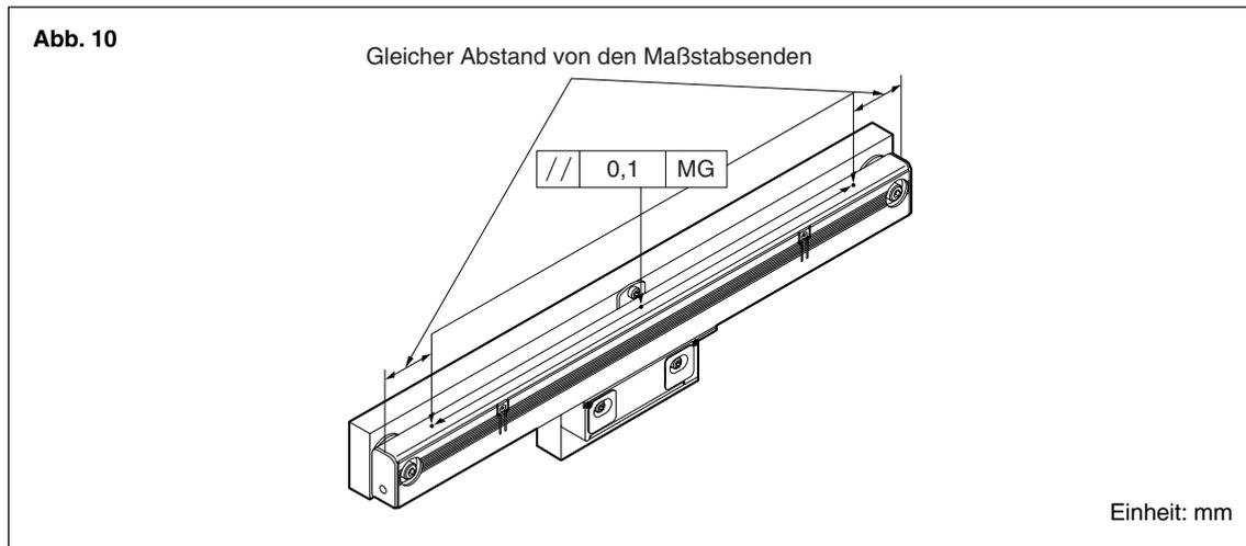
3. Führen Sie das mitgelieferte Abstandsstück ( $t = 1,0 \text{ mm}$ ) in den Spalt zwischen Maßstab und Schieber ein, und stellen Sie dann die Schieberposition ein, während Sie den Schieber mit dem Maßstab in Berührung bringen.
