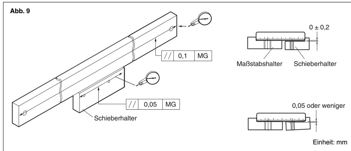
2. Stellen Sie die Parallelität in Bezug auf die Maschinenführung der Maßstabsrückseite ein, während Sie die Maßstabsrückseite mit einer Messuhr messen\*. Ziehen Sie die Befestigungsschrauben an.
